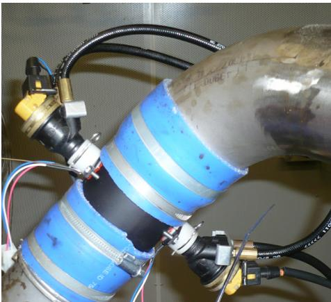
Vstřikovače LPG jsou umístěny za chladičem plnicího vzduchu, před plnicím potrubím motoru. Přívod LPG do plnicího vzduchu není synchronizován se sacím zdvihem, velikost dávky určuje frekvence a doba otevření EV vstřikovače LPG.
