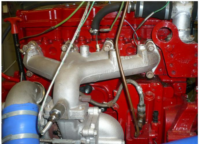
Pohled na výfukovou stranu motoru: teplota výfukových plynů je měřena na výstupu z každého válce motoru (významné z hlediska kvality směsi) v jednotlivých válcích a před turbínou.
